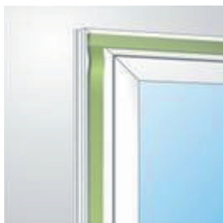
Bild 1: Bandverlegung bei der Fenstermontage
